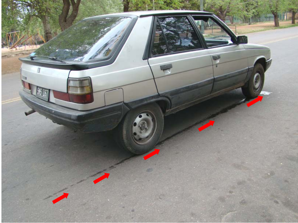
REGUERO LIQUIDO DEPOSITADO SOBRE LA CALZADA LUEGO DE UNA FRENADA.
