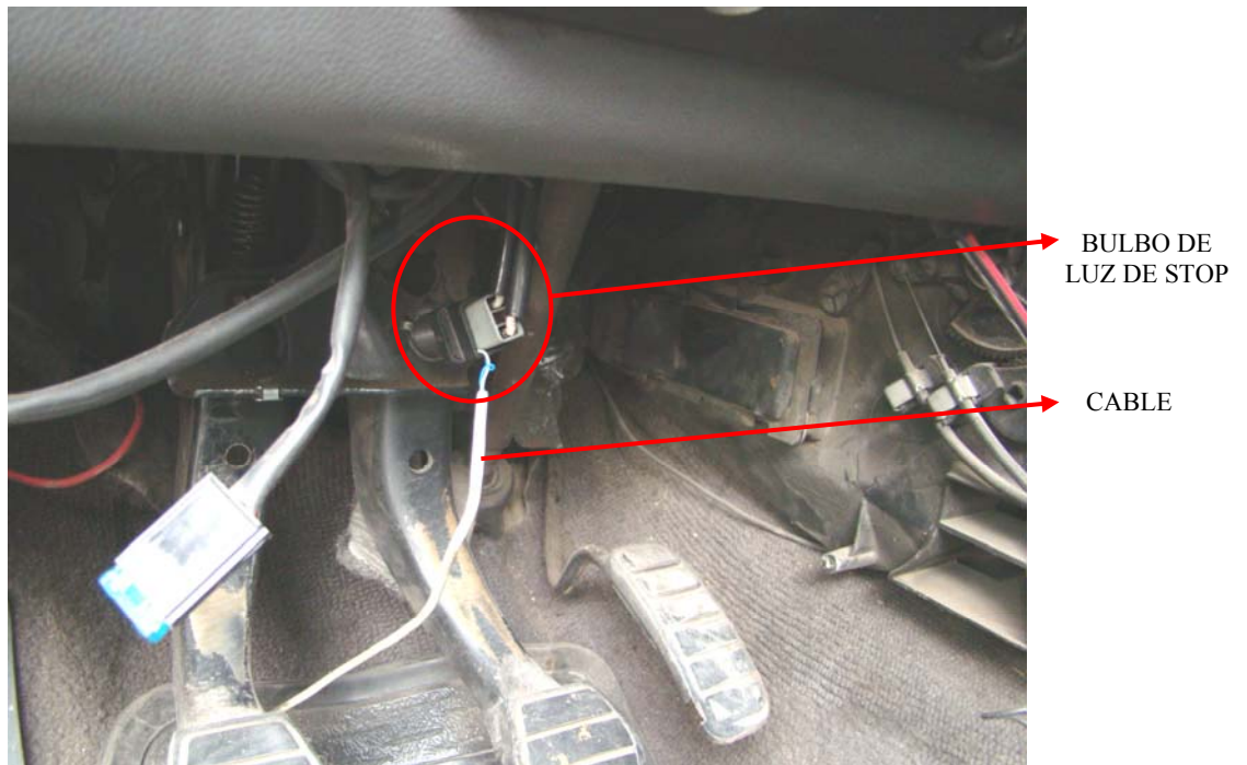
EL EXTREMO DE UN CABLE FUE CONECTADO AL BULBO DE LA LUZ DE STOP.
