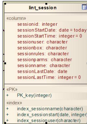
Figura 8: Tabla de base de datos de OpenEdge con UML Fuente: Modeling Existing ABL Systems with UML
