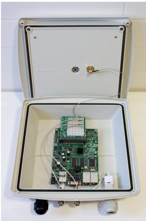
**Ilustración 42 - Caja estanca, router y radio <sup>39</sup>-**
