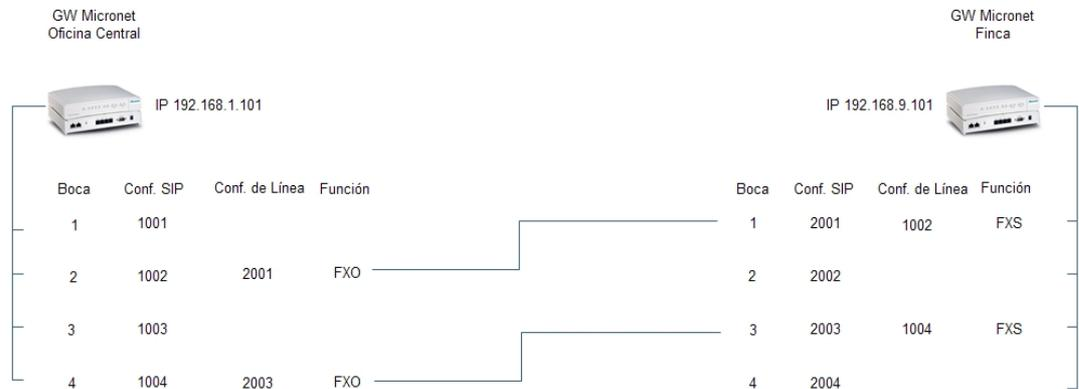
**Ilustración 54 - Resumen de configuración SIP y de Línea de los GWs Ip<sup>54</sup>.**
