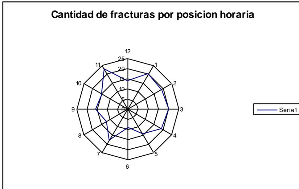
Ilustración 90°- 4: Cantidad de Fractura radiales por posición horaria
