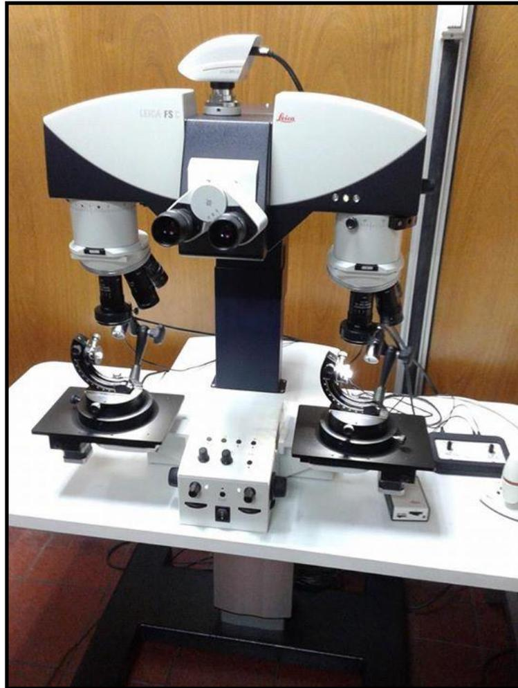
**Imagen N°22:** estudio de tejido textil en microscopio comparador balístico Leica FSC.
