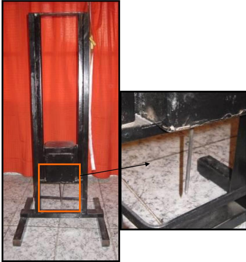
**Imagen N°17:** Soporte contenedor del arma punzante o perforante.
