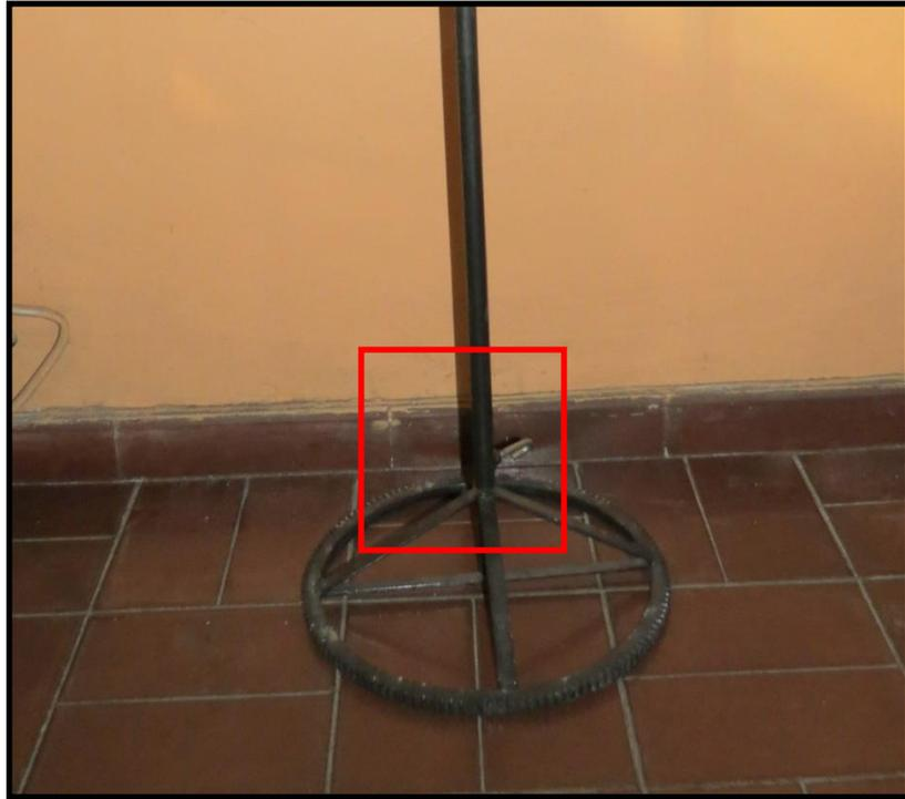
**Imagen N°14:** gancho para regular altura de bastidor.
