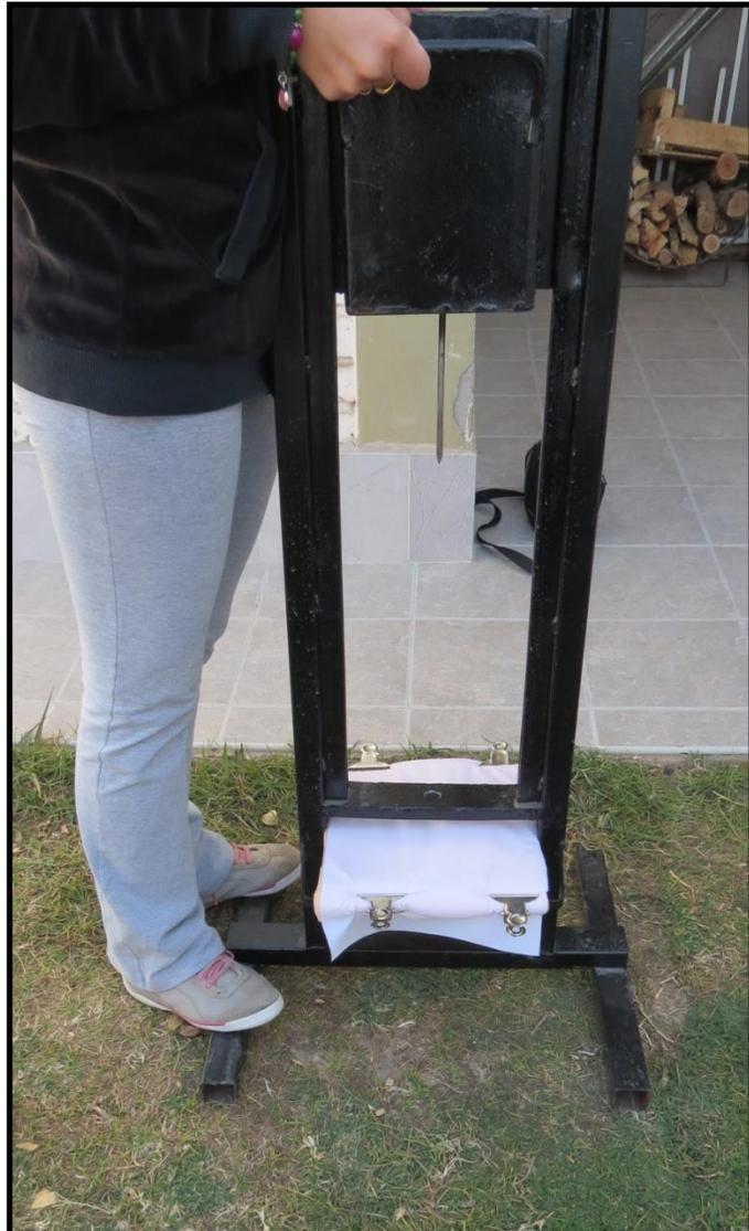
**Imagen N°25:** material colocado en bastidor y masa suspendida.
