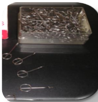
Ilustración N°9: Ganchos para el montaje de las muestras Fuente: elaboración propia
