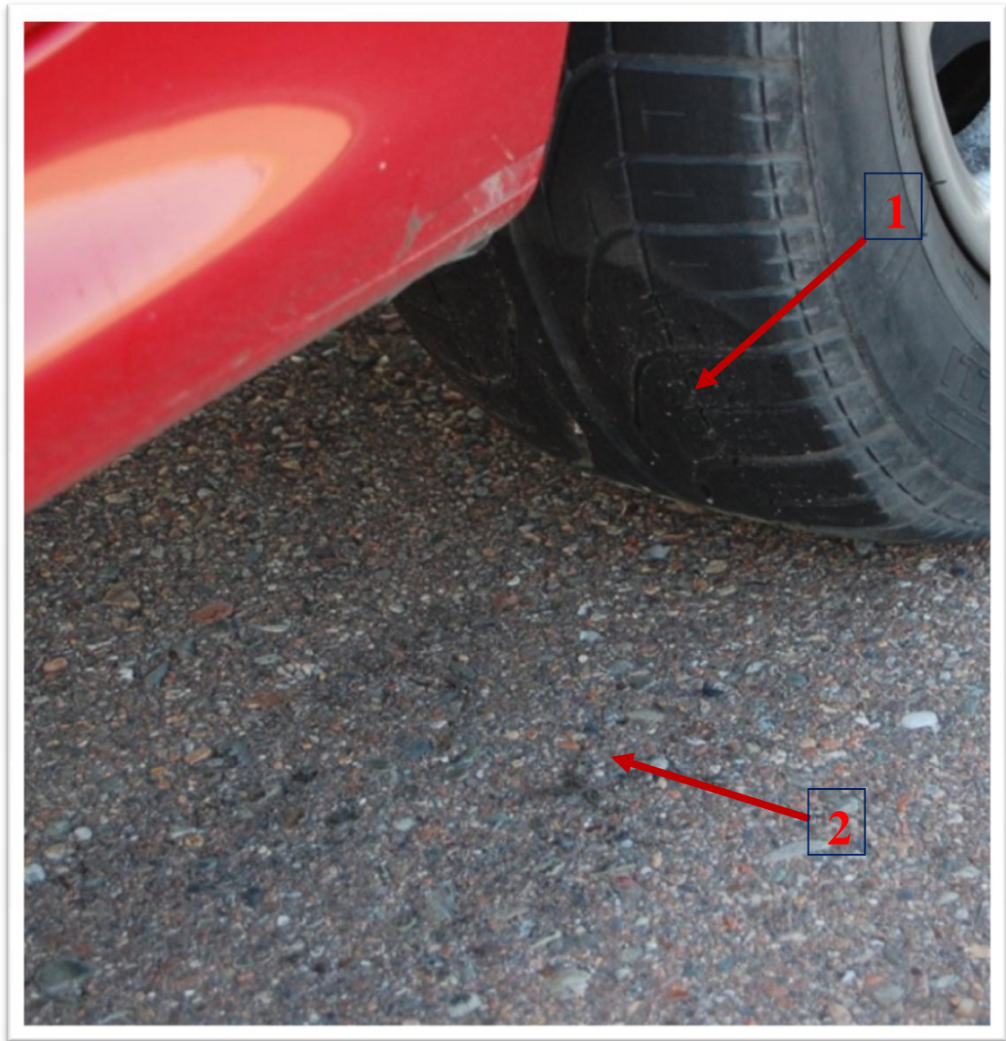
Ilustración n° 12: imagen restos de caucho y abrasión en rueda delantera, se indica en el punto 1 el sector de la banda de rodamiento con el desgaste del frenado y en el punto 2 los restos de caucho en la calzada. Fuente: elaboración propia.
