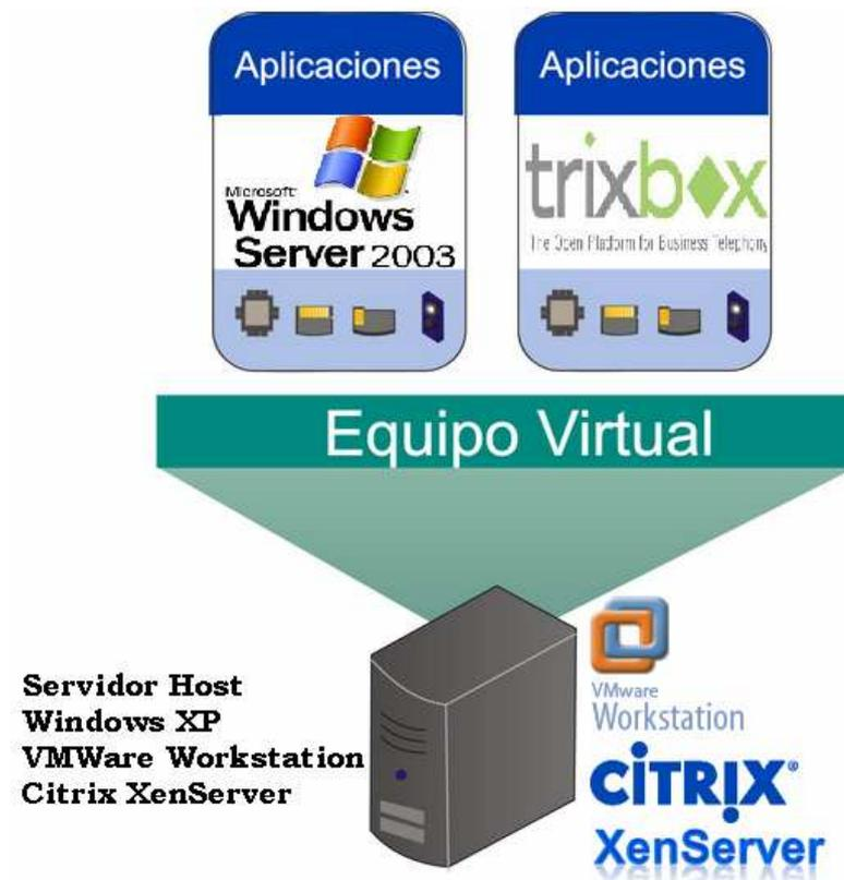
Figura 16: Modelo del sistema Virtualizado.
