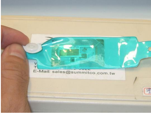
Imagen 4 - Chip RFID dentro de un brazalete.
