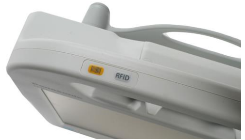
Imagen 9 - CF-H1 botones para activar lector de RFID o código de barras.
