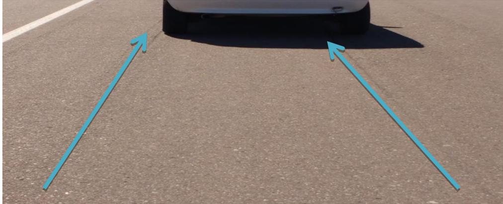
Ilustración n°16 (Longitud de huella de frenado con 4 ocupantes con una medida de 4,68 metros).
