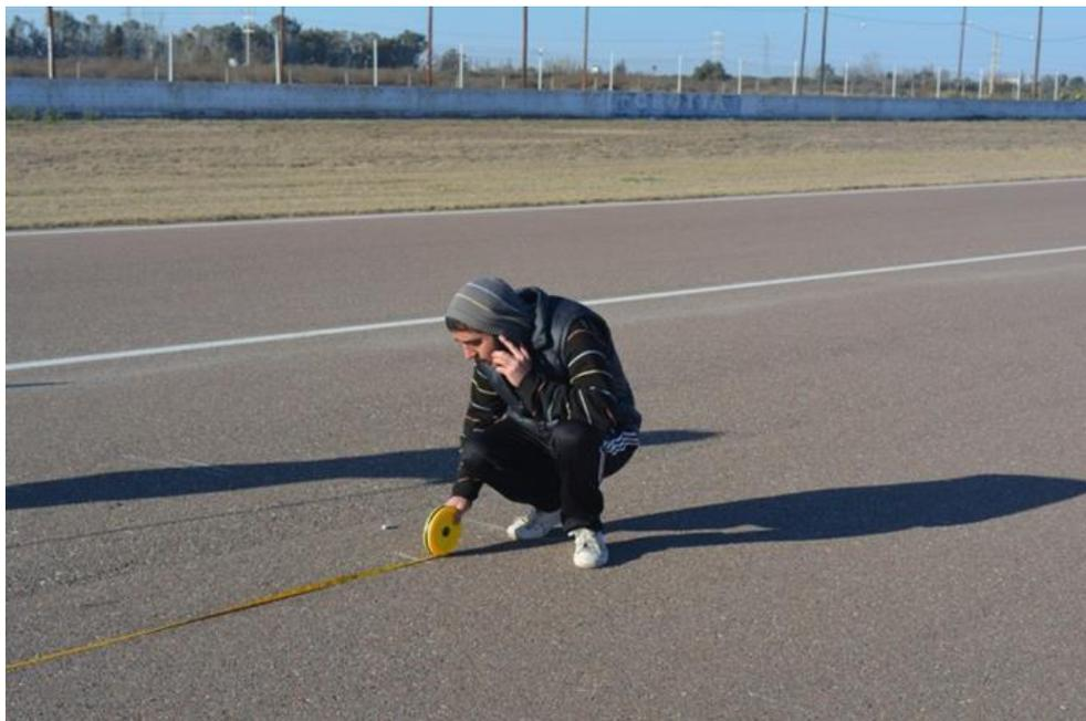
Ilustración n°9 (Medición de una longitud de huella con 4 ocupante)
