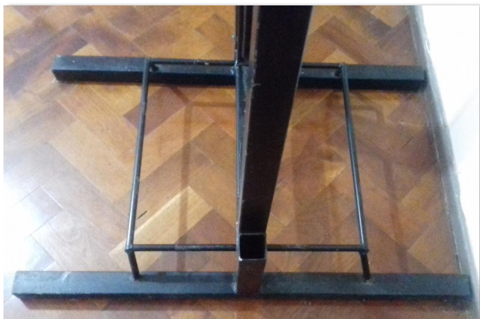
Imagen N°42: Bastidor de hierro de 40 cm de lado en el que se monta la porción de textil modal.
