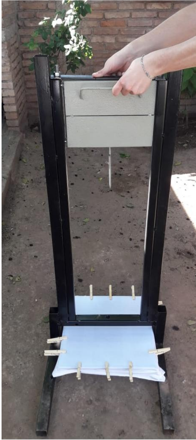
Imagen N°5: Montaje de tela en el dispositivo de arma blanca. Arma blanca arriba, pre-perforación.
