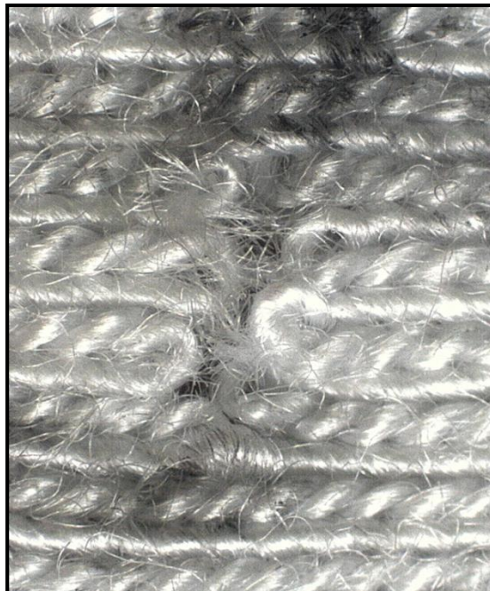
Imagen N°35: Ausencia de deformación del tramado en la Muestra N°13 obtenida por el traspaso del proyectil calibre .22lr.
