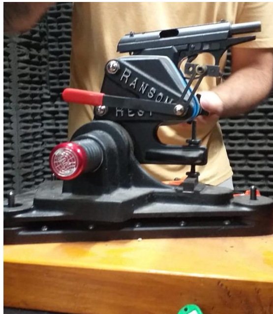
Imagen N°9: Montaje del arma de fuego en el dispositivo de sujeción Ransom Rest.
