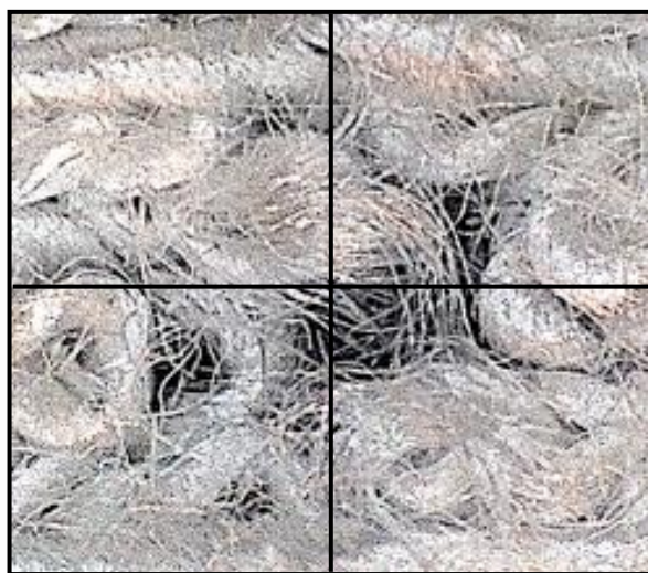
Imagen N° 3: Representación de la división por cuadrantes de una rotura en tejido textil modal. Fuente: Elaboración propia.
