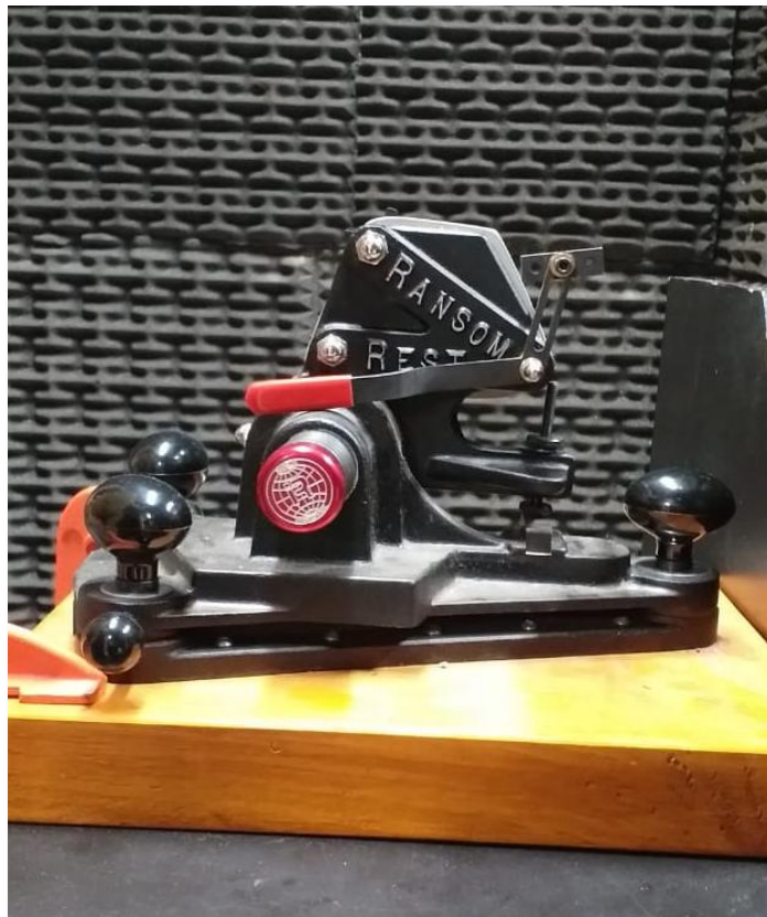
Imagen N°17: Dispositivo de sujeción del arma, marca Ransom Rest. Fuente: Elaboración propia.
