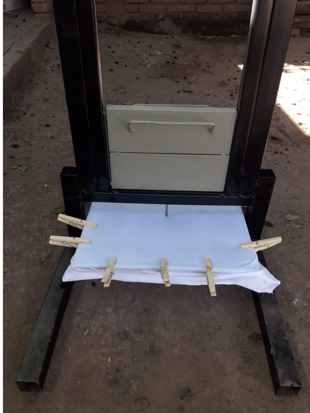
Imagen N° 6: Arma blanca abajo, perforando el tejido textil modal montado en el dispositivo.
