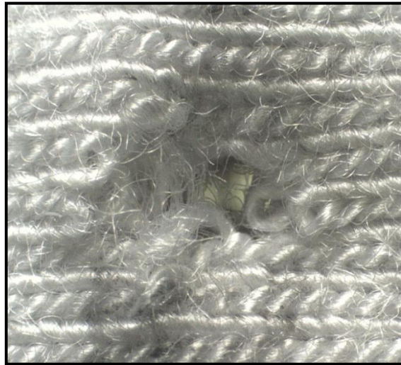
Imagen N°26: Presencia de pérdida parcial de material correspondiente a la Muestra N°3 obtenida por proyectil calibre .22LR
