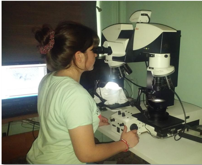
Imagen N°22: Observación de rotura presente en fragmento de tejido textil modal, utilizando Microscopio comparador balístico e iluminación directa.
