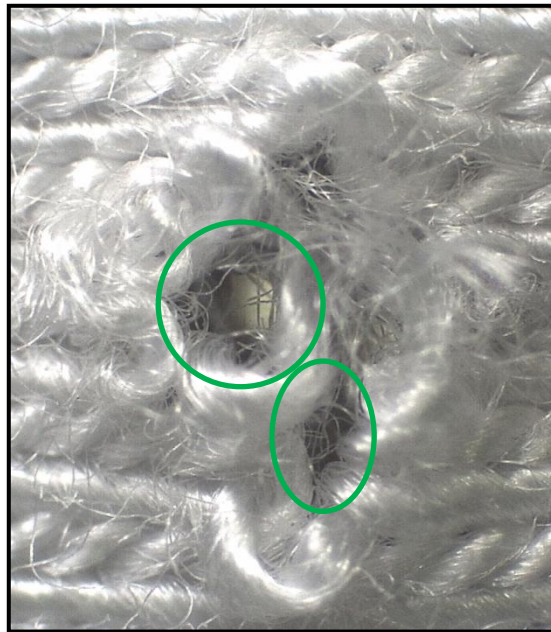
Imagen N° 24: Presencia de pérdida parcial de material correspondiente a la muestra N°16 obtenida por acción de arma blanca punzante impropia.
