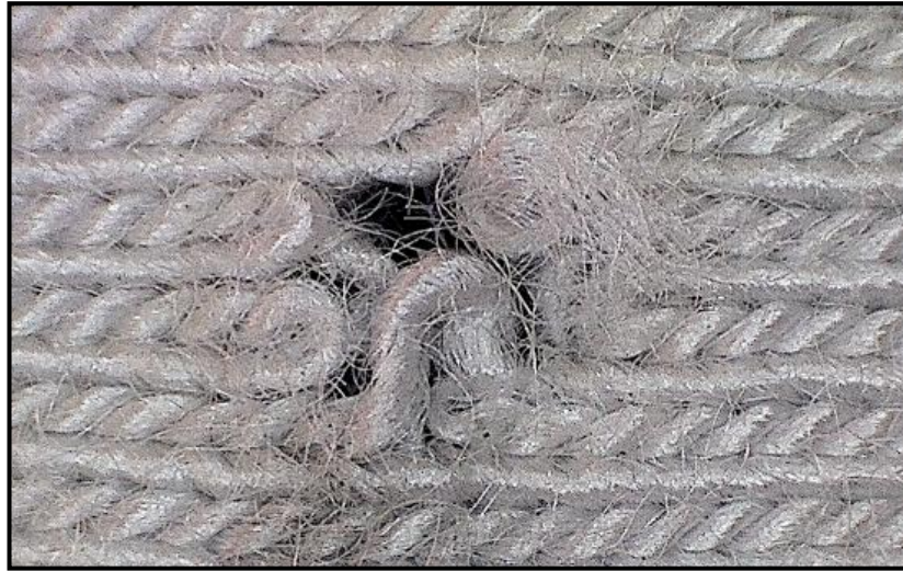
Imagen N°33: Ausencia de deformación del tramado en la Muestra N° 11 obtenida por el traspaso de arma blanca punzante impropia.
