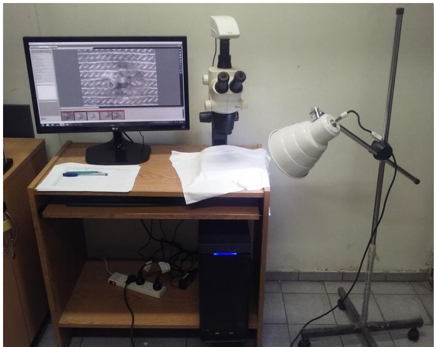
Imagen N°21: Observación de rotura presente en fragmento de tejido textil modal, utilizando Lupa binocular estereoscópica e iluminación directa.
