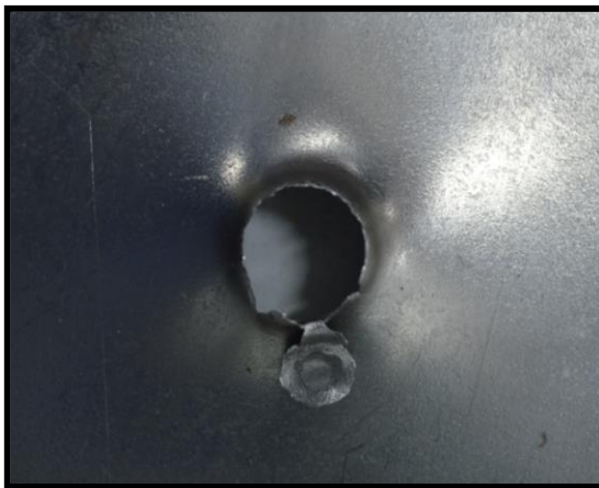
Imagen n° 9 (izquierda), orificio de impacto “Sin pérdida de tapón” – Imagen n° 10 (derecha), orificio de impacto con pérdida de tapó
